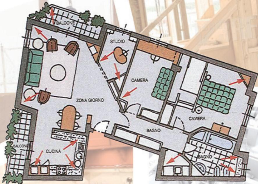
Esempio di angoli da misurare attentamente in fase di costruzione, ma ancor di più per la realizzazione e installazione dell'arredamento.
