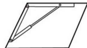
Angolfast è costruito in alluminio anodizzato, risulta quindi robusto ma nello stesso tempo leggero e maneggevole. Dotato di livella in plastica antiurto ed è capace di misurare angoli interni compresi fra 20° e 135°.
